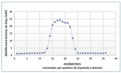
**Fig. 6.** Razón de las lecturas obtenidas por Giap<sup>(4)</sup> y la simulada en GATE.
