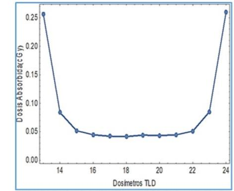
Fig. 3. Dosis absorbida (cGY) en cada dosímetro del cilindro central, numerados desde el 13 hasta el 24.
