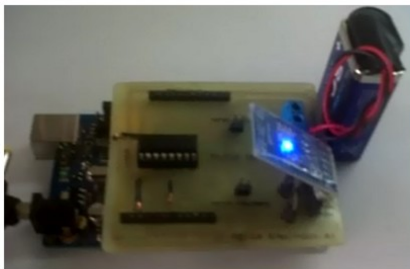
Figura 3. Circuito electrónico y comunicación bluetooth entre la tarjeta Arduino y la aplicación LabVIEW.
